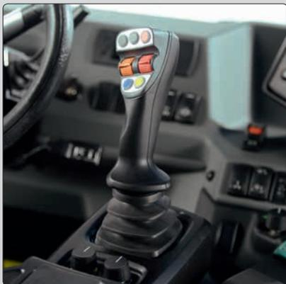
Ein **Joystick** mit Armlehne, auf dem die wichtigsten Hydraulikfunktionen, Fahrtrichtungswechsel, Wechsel der Lenkungsarten, PTO-Modus und Tempomatfunktion verfügbar sind, ermöglicht eine ergonomische Bedienung.
