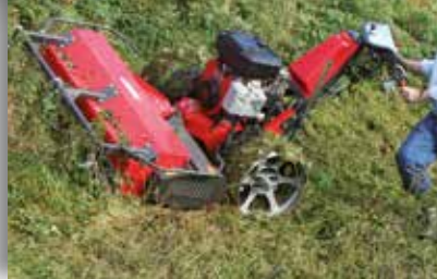
UBS Alpin met klepelmaaier (135 cm werkbreedte)
