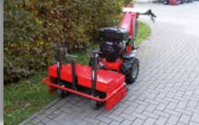
UBS Hydro met onkruidverwijderaar
