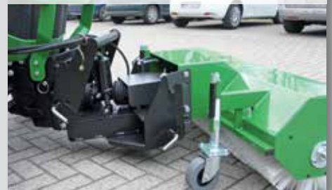
Gelenkwellenbetriebene Kehrmaschine an Quick Hitch Aufnahme
