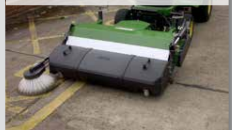
Kehrmaschine mit Sammelbehälter und Seitenbesen
