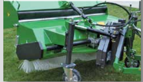
Kehrmaschine am Frontkuppeldreieck mit hydraulischer Schwenkvorrichtung
