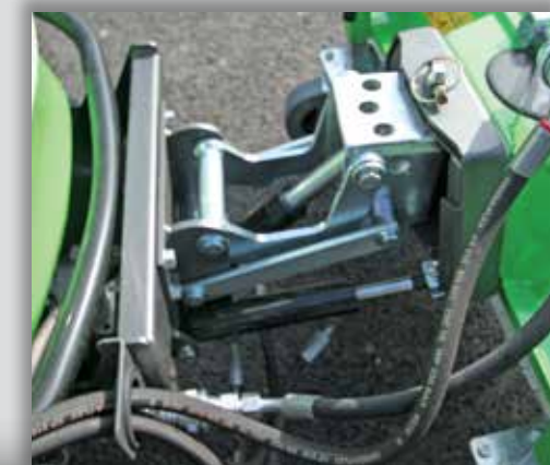
Hydraulische Schwenkvorrichtung für Aufsitzrasenmäher
