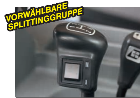
Die 8 Vorwärtsgänge werden auf Knopfdruck mit der Splitting-(Halb-) Gruppe in 16 Gänge unterteilt und schaffen eine noch feinere Geschwindigkeitsabstufung.
