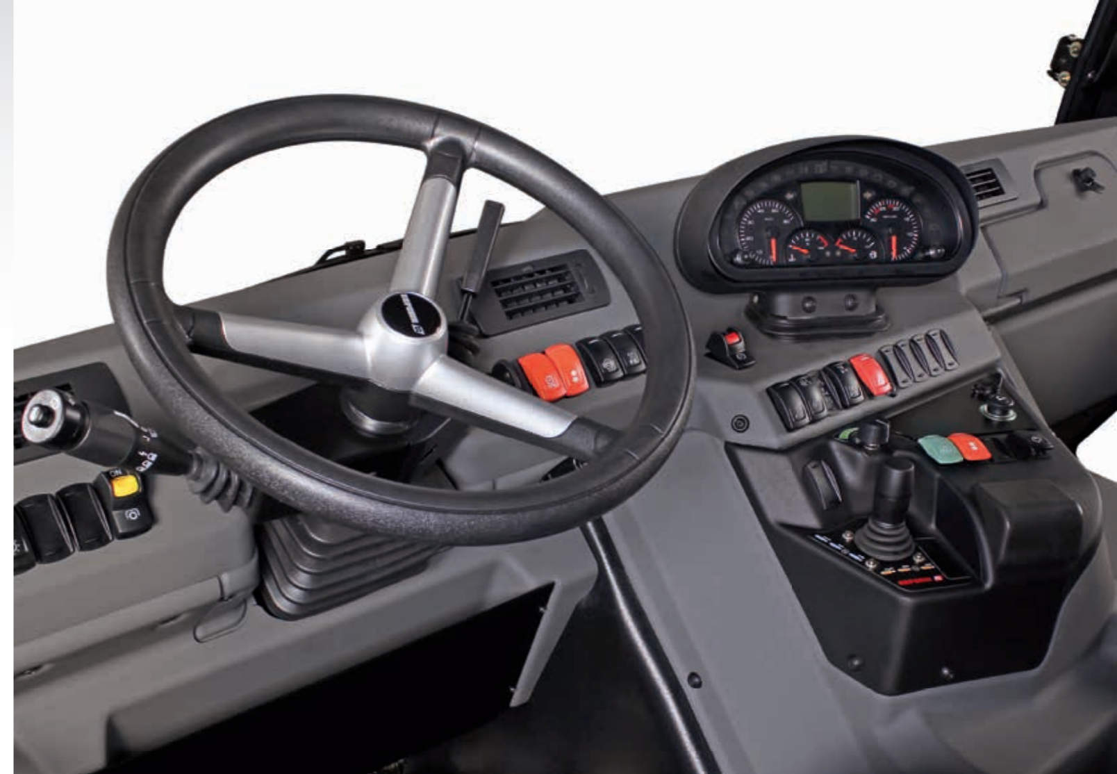
Die 8 Vorwärtsgänge werden auf Knopfdruck mit der Splitting-(Halb-) Gruppe in 16 Gänge unterteilt und schaffen eine noch feinere Geschwindigkeitsabstufung.
