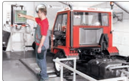
Alle Fahrzeuge werden vor der Auslieferung einer intensiven Funktionsprüfung wie z.B. Rollenleistungsprüfstand (Bild) unterzogen.
