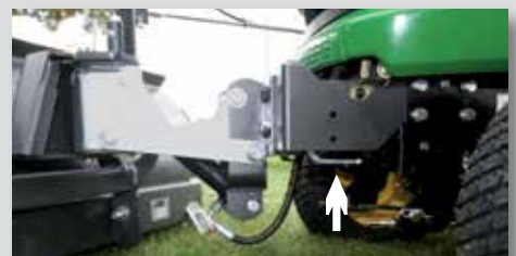
Einfacher Gerätewechsel durch Spezial-Kuppeldreieck, 3-Wegehahn zur Aushebung vom Mähwerk/Schneeschild
