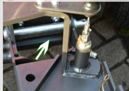
Schneller Gerätewechsel mit nur einem Bolzen
