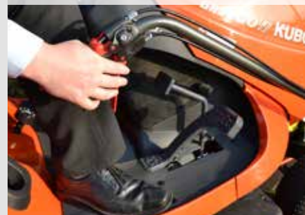
Mechanische Aushebe-/ Schwenkvorrichtung über einen Hebel
