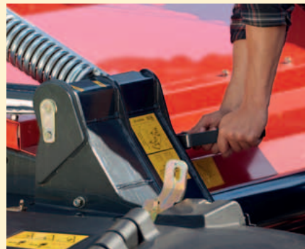
Einfache Einstellung der Aufbereitungsintensität.
