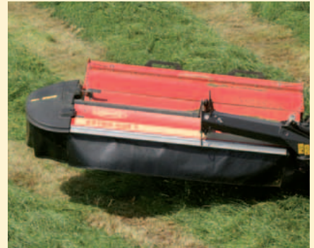
Einfaches Anheben am Vorgewende ohne Betätigung der Dreipunkthydraulik am Schlepper.
