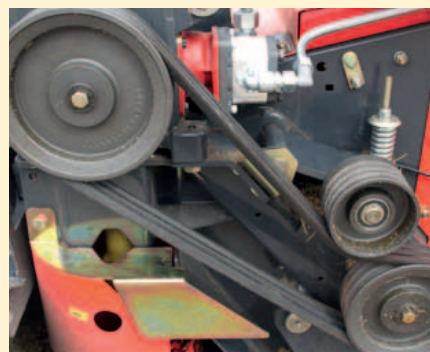
Die einstellbare Rotorgeschwindigkeit sorgt für eine Kraftstoffersparnis.
