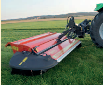
Gezogene Aufhängung für gleichmäßige Gewichtsverteilung und exzellente Anpassung.
