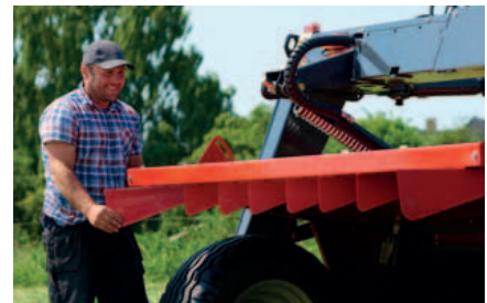
Die beiden Schwadleitbleche werden ausgebaut.
