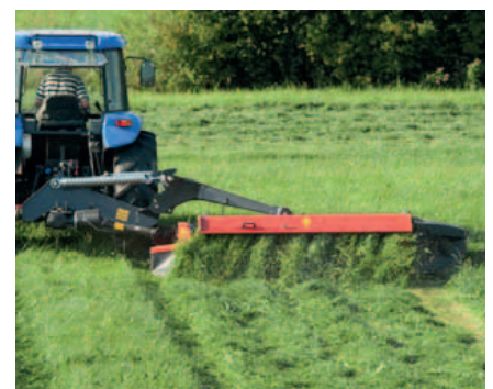
Schnelle Umstellung von Schwadablage auf Breitablage.
