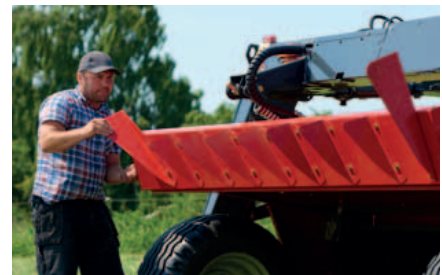
Zum Umschalten zwischen Schwadablage und Breitsreuen werden die Streuflügel einfach um 180° nach oben gedreht.
