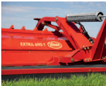
Die Schwadablegebänder von Vicon sind einzeln aufgehängt – für gleichmäßige Schwadformung.
