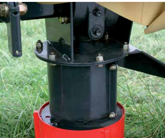
Rechtstreekse aandrijving op de eerste schijf is de meest efficiënte krachtenoverbrenging.
