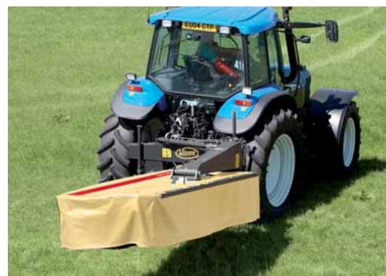
De maaier klappt hydraulisch in de transportpositie, dicht achter de trekker.
