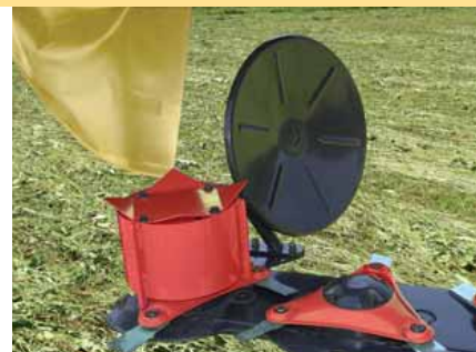
Zwadschijf om het gemaaide en het ongemaaide gras te scheiden.
