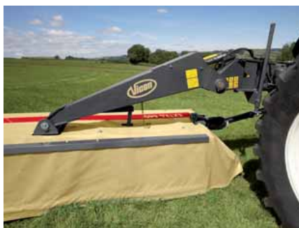
Middenophanging voor een gelijkmatige gewichtsverdeling.
