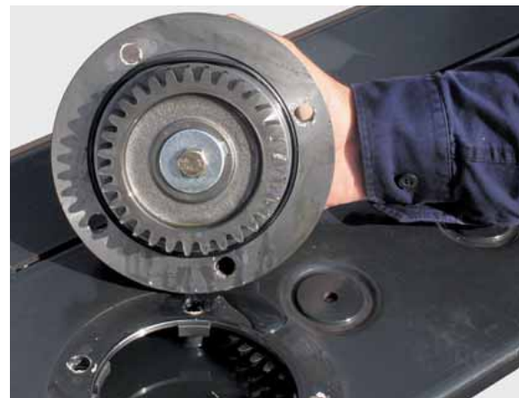
Alle lagerhuizen zijn eenvoudig uit te nemen voor onderhoudswerkzaamheden.
