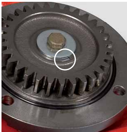
Elke maaischijf is individueel beveiligd tegen overbelasting van de aandrijving.
