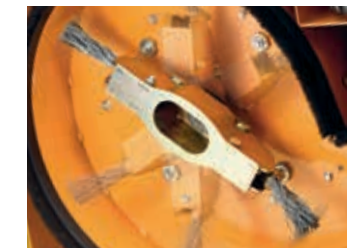
Hard tegen hardnekkig onkruid: Het gepatenteerde pendelborstel-systeem werkt contouraccentuerend – de centrifugale kracht regelt de aandrukkraft van de borstels en ontziet daardoor de oppervlakken.
