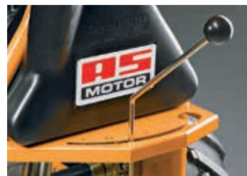
De schakelaandrijving met 5 versnellingen met sper-differentieel zorgt ook op een vochtige ondergrond voor optimale voortstuwing.
