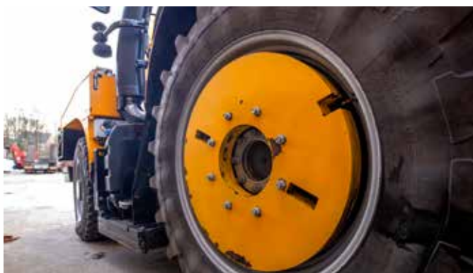
Nog een optie voor extra stabiliteit: wielgewichten. Water in de voor- en achterbanden is ook een prima mogelijkheid voor extra stabiliteit.
