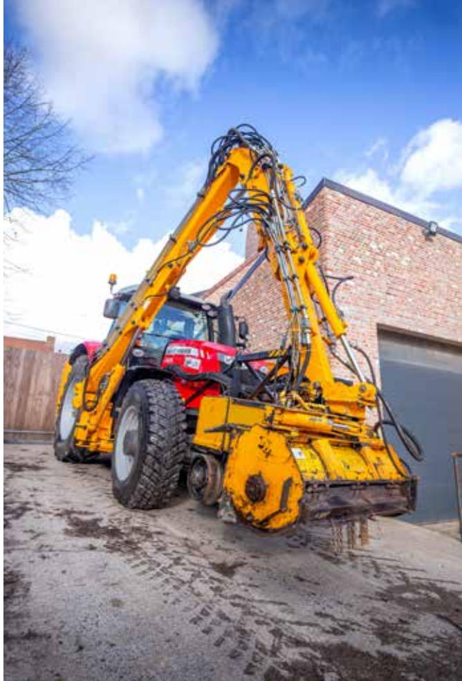
De standaard Grenadier maaiarmen zijn tweedelig en 6,4 tot 8,8 of zelfs maximaal 11,0 m lang.
