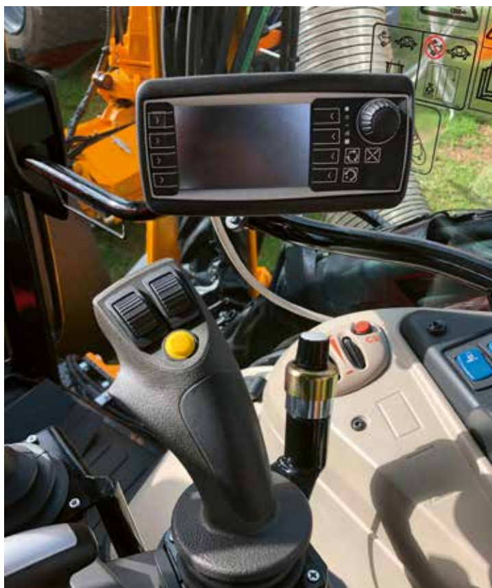
Met de HCC-besturing en joystick wordt de Grenadier vanuit de cabine bediend.
