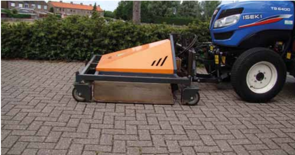
'De Weed Air 150 zetten we in voor kleine onkruiden tussen de straatstenen', aldus Van Hennik.
