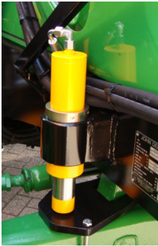
Voorasstabilisatie is geen overbodige luxe. Links voor een vaste vooras en rechts voor een geveerde vooras.
